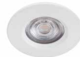
F DIVE SL261 RD 070 5.5W 27K W HV IP65R 8718699755720 → 85 1 55 mm (výřez Ø70 mm) 5,5W, 350 lm @ 2700 K
