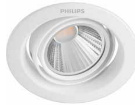
F 59555 POMERON DIM 070 5W 27K EU RECESSED 5955531 8718696173794 → 90 l 67 mm (výřez Ø70 mm) 5 W, 330 lm @ 2700 K
