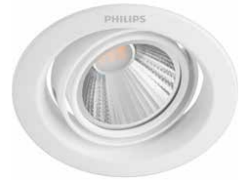
F 59555 POMERON DIM 070 5W 40K EU RECESSED 5955531000 8718696173800 → 90 l 67 mm (výřez Ø70 mm) 5 W, 350 lm @ 4000 K
